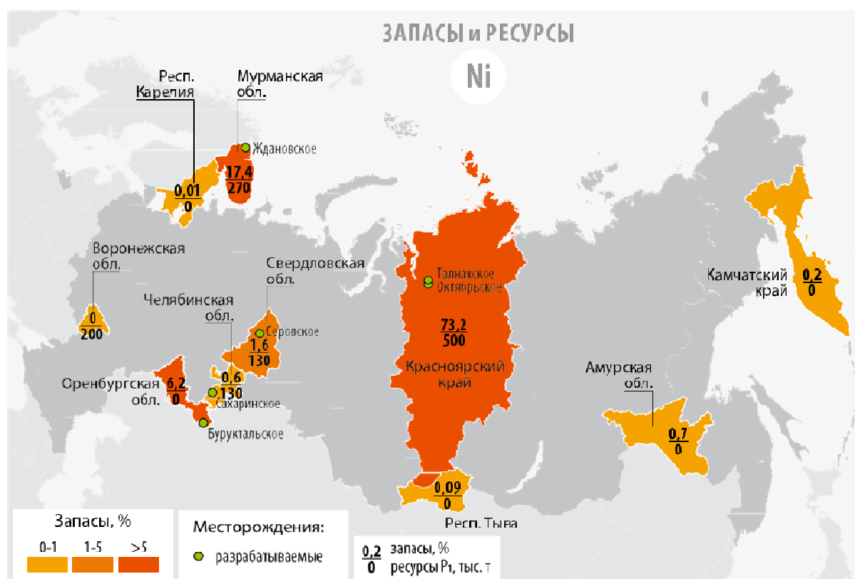
Рисунок 1.5 — Основные месторождения никеля и распределение его запасов, % и прогнозных ресурсов категории P1 (тыс. т) по субъектам Российской Федерации ([32])
